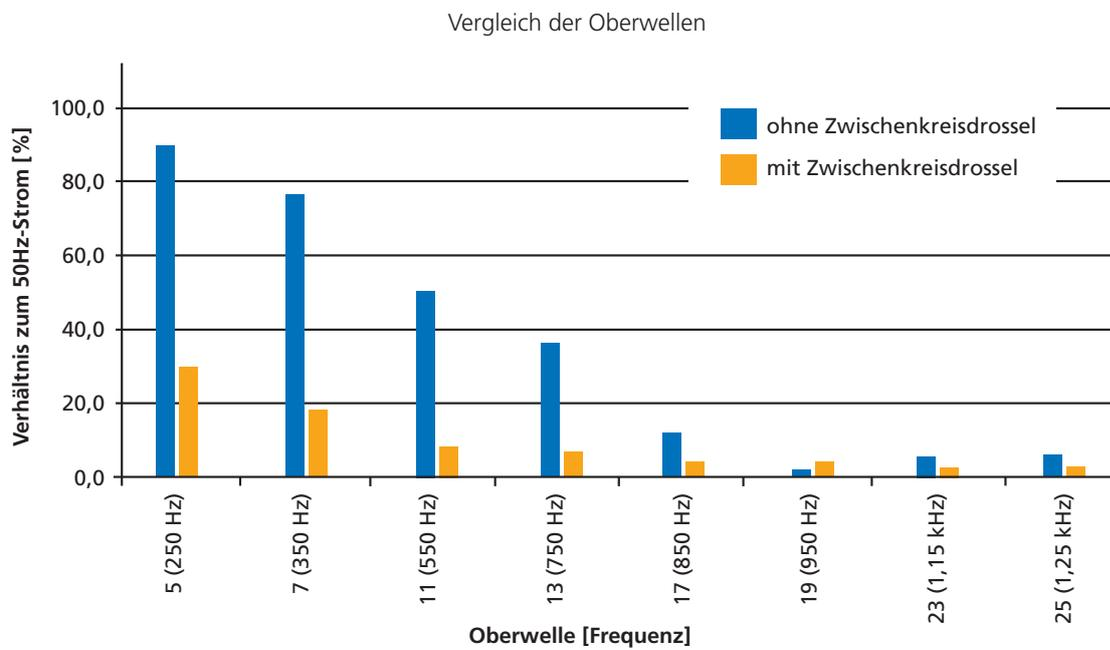
Es ist eine deutliche Abnahme der Oberwellen zu sehen. Durch eine Zwischenkreisdrossel wird das Versorgungsnetz weniger mit Oberwellenblindleistung belastet.
